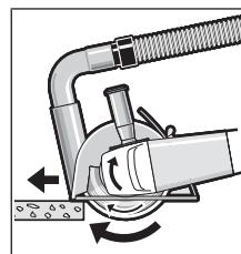
Conecte la herramienta eléctrica y colóquela con la parte delantera del carro guía sobre la pieza de trabajo. Desplace la herramienta eléctrica con un avance moderado, adecuado para el material a mecanizar.
