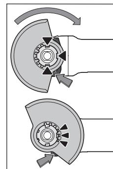
Coloque la cubierta protectora (8) sobre el alojamiento en la herramienta eléctrica, hasta que coincidan las levas de codificación de la cubierta protectora con el alojamiento. Presione y sujetelo en ello la palanca de desenclavamiento (1).
