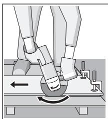
A ferramenta elétrica deve sempre ser conduzida no sentido contrário da rotação. Caso contrário, existe perigo de a ferramenta ser pressionada de forma **descontrolada** sobre o corte. Ao separar perfis e tubos quadrados comece de preferência na seção transversal mais
