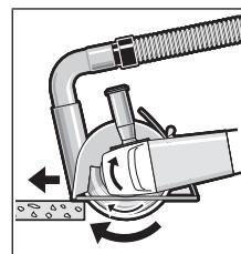
Ligue a ferramenta elétrica e coloque-a com a parte da frente do carrinho guia sobre a peça. Deslize a ferramenta elétrica com uma alimentação moderada, adequada para o material a ser trabalhado. Ao cortar materiais especialmente duros, como p. ex. betão com alto teor de sílex, é possível que o disco de corte diamantado seja sobreaquecido e danificado. Uma coroa de faíscas em volta do disco de corte diamantado é um indício nítido.
