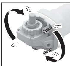
Puede girar la cabeza del engranaje en pasos de 90 °. De este modo, el interruptor de conexión/desconexión puede situarse en una posición de manejo más adecuada para casos especiales, por ejemplo, para zurdos.
